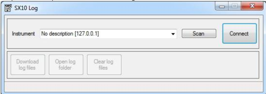
2) Нажмите кнопку «Поиск» и выберите IP-адрес требуемого тахеометра:
